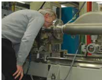
Roy Engebretsen fra Aker Solution på FAT for Coriolismålere følger nøye med under en kalibrering.
