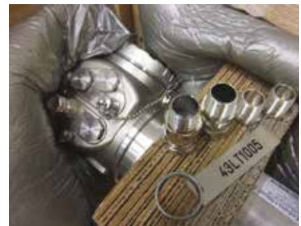
Gamma transmittert – Klargjort for inspeksjon.
