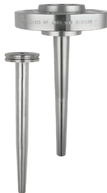
Vanstone termometerlomme der flens og lomme er to separate deler gir lavere innkjøpskostnad og redusert lagerhold
