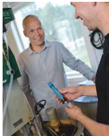
Jonas Ekström bytter ut en gammel med en nykalibrert pH-elektrode sammen med Tommy Eierholen, salgsingeniør på Endress+Hauser. Med prekalibrerte elektroder går byttet raskere, og blir både enklere og sikrere.
