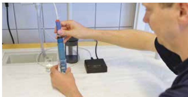
Kalibrering av pH-elektroder på laboratoriet med Memobase Plus. Ubekvemme og kronglete kalibreringer ute på stedet er nå historie.
