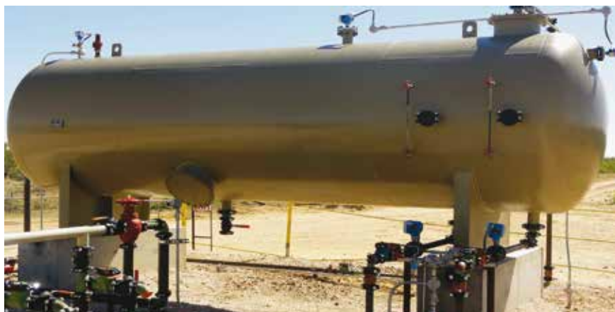
I separasjonstanken vil oljen legge seg på toppen og vannet i bunnen, og kapasitive nivåmålere vil måle grensesnittet.
