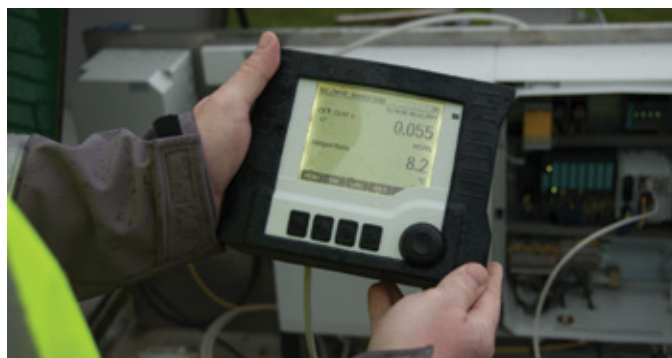
Det er lett å avlese displayet, det ligner den stasjonære transmitteren. Her er sees både verdien av ledningsevnen og temperatur i brønnen.
