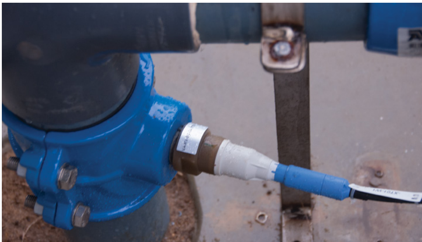
Ute i terrenget er ledningsevneelektroden montert direkte på pumperøret fra hver brønn.
